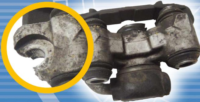
> Patte de fixation du câble de frein à main déteriorée
